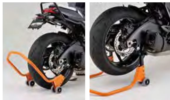
車体が傾いている状態からスプールのままにセットされ続けるため、外れやすい状況を回避します。
